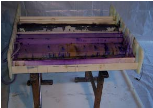
Bild 5, Demontage und Reinigung des Entwicklertanks
