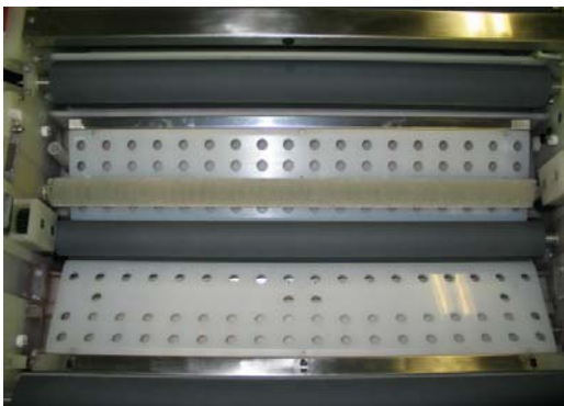
Bild 13, Entwicklertank mit Plattenführung, neuen Walzen und Bürste
