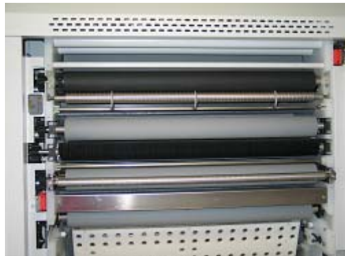
Bild 14, hinterer Bereich des Tanks Spülsektion, Gummierung, Trocknung
