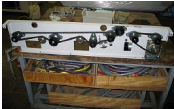
Bild 6, Demontage von Ketten und Lager der Antriebseinheit
