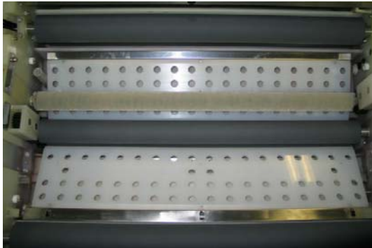
Bild 2, Entwickler mit einer Bürste, z.B. für die Verarbeitung von Electra XD und Excel Druckplatten
