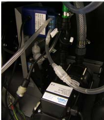
Bild 3, Regenerat wird über robuste Balgpumpe zugeführt
