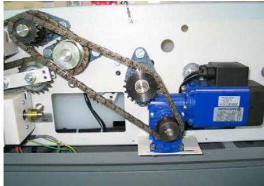
Bild 12, linke Maschinenseite Spülwalzenantrieb neuester Bauart
