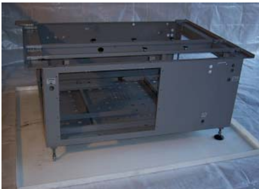
Bild 7, Untergestell nach dem Reinigen und Lackieren
