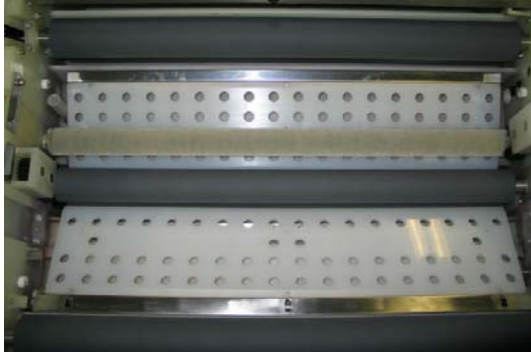
Bild 2, Entwickler mit modifizierter Plattenführung und Kühltülle
