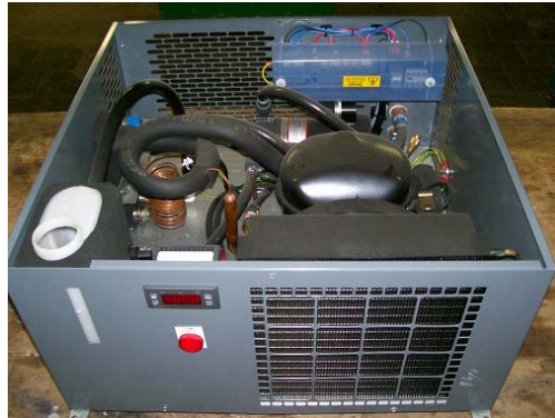
Bild 12, Kühlaggregat mit Wasserkreislaufsystem
