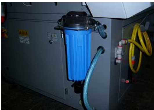
Bild 4, Entwicklerfilter mit integriertem Absperrventil (neues Kühlsystem mit einem Entwicklerfilter)
