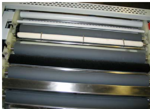
Bild 16, hinterer Bereich des Tanks mit Spülsektion, Gummierung und Trocknung
