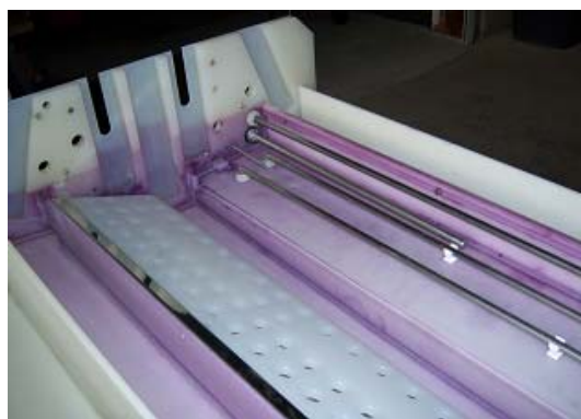
Bild 10, Entwicklertank bei der Montage mit modifizierter Plattenführung u. Kühltülle
