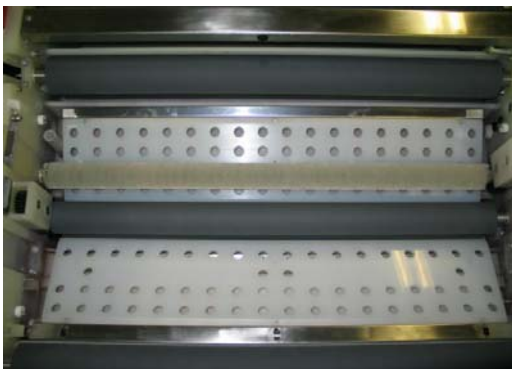
Bild 15, Entwicklertank mit modifizierter Plattenführung und neuen Walzen und Bürste
